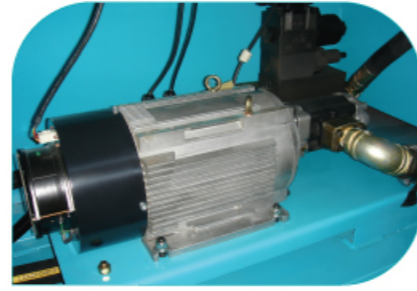
伺服馬達利用編碼器及壓力感應器，作流量壓力全閉迴路控制。
